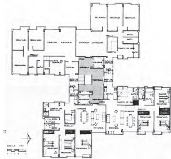
Planta tipo de departamento en forma de cruz. Fuente: Instalaciones Olímpicas. Secretaría de Obras Públicas, México, Secretaría de Obras Públicas, 1968, p. 331
