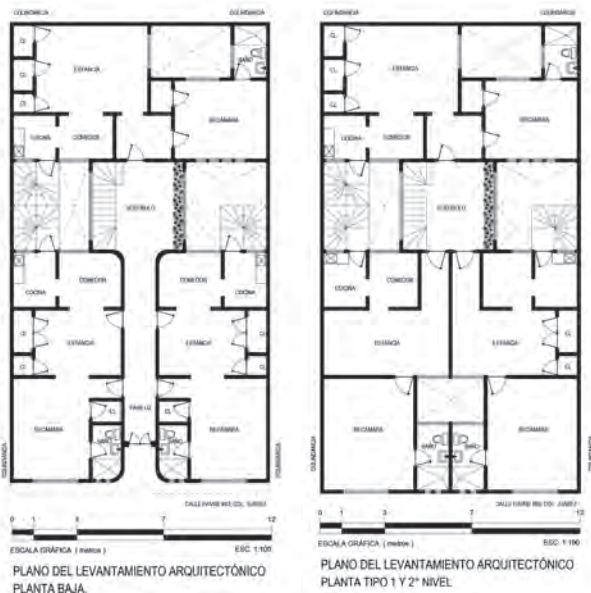
Planta del edificio de apartamentos en Havre núm. 83, colonia Juárez. Dibujo realizado por Ricardo Álvarez, 2017, a partir del levantamiento de Javier Velasco, 2013
